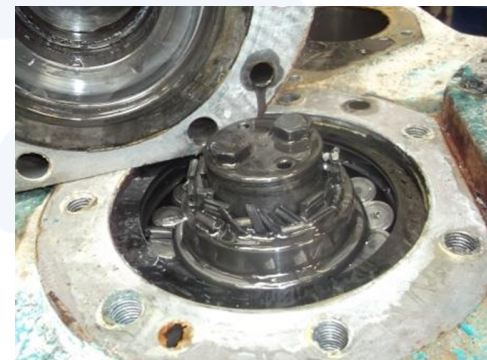
Teruglooprem en onderliggend lager defect
